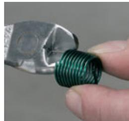
Der HELICOIL® plus mit der entsprechenden Windungszahl „W“ wird anhand einer Tabelle (siehe Einbaubeschreibung) ausgewählt. Bei Bedarf wird der HELICOIL® plus mit dem Seitenschneider auf die entsprechende Anzahl von Windungen gekürzt.
