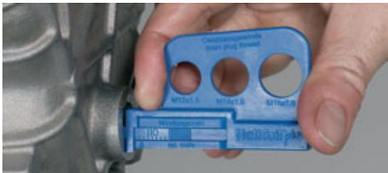
Nach dem Schneiden des HELICOIL® plus Aufnahme-gewindes wird mittels der Schieblehre die Anzahl der benötigten Windungen des einzusetzenden HELICOIL® plus ermittelt. In dem gezeigten Beispiel wird bei der Abmessung M 14 x 1,5 eine Windungszahl von 8,5 angezeigt.
