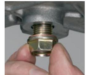
Für die originalen Verschlussstopfen mit Bund ist eine ausreichend große Dichtringauflage vorhanden. Es sind keine Sonder-Verschlussstopfen mit Übermaß bzw. Verschlussstopfen in größerer Abmessung notwendig.
