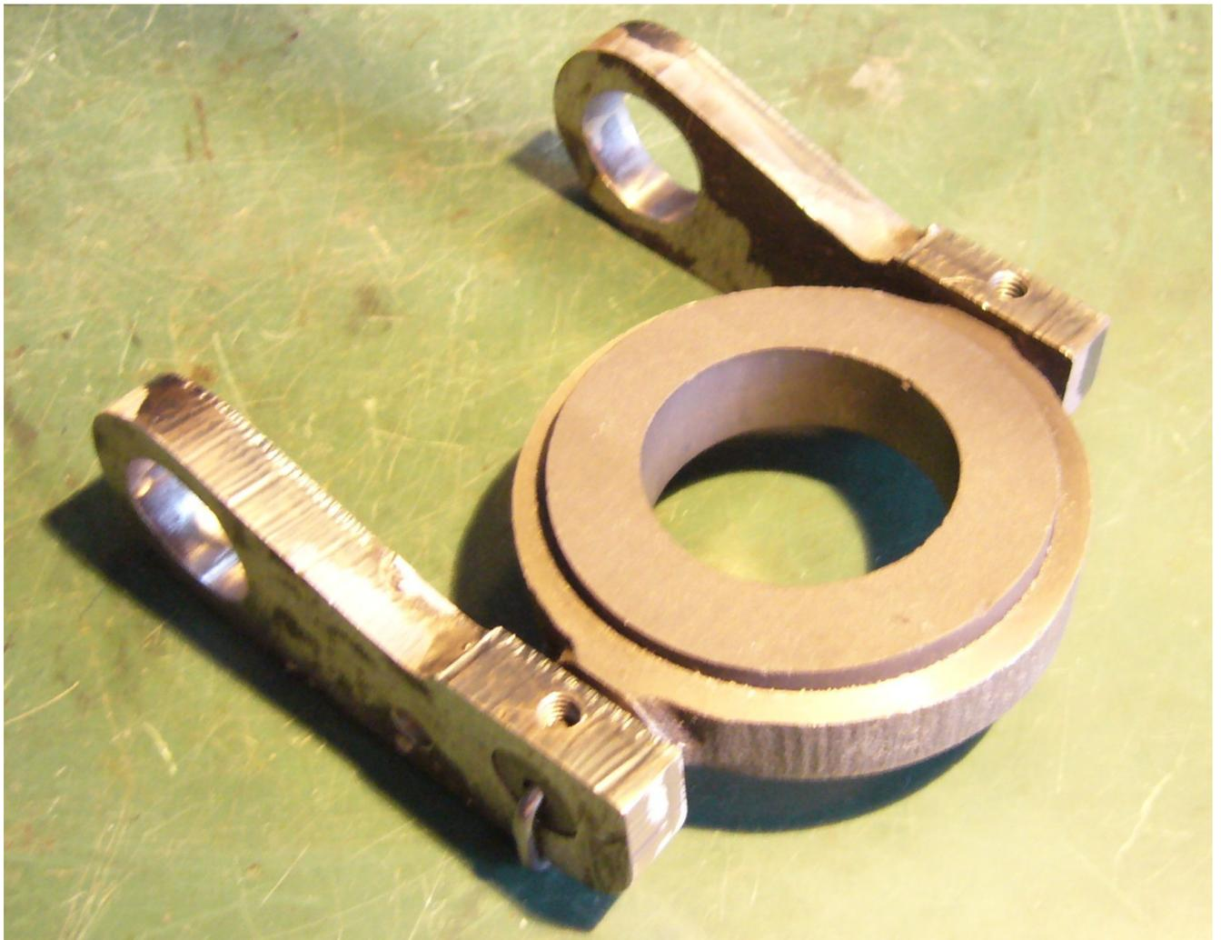
*Auf diesem Bild wird die Winkelstellung mit einer Welle D 14 h9 von einem noch festen Hebel auf die andere Seite des Bundes auf einen neuen Hebel übertragen, und geheftet.*
