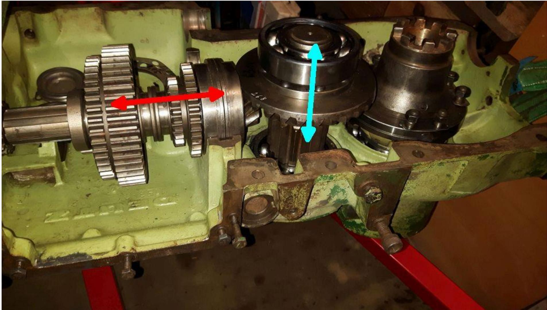
**Blauer Pfeil:** Einstellung über die Beilagebleche incl. Papierdichtung auf beiden Seiten! Dazu Deckel verschraubt montieren, Tragbild ermitteln – meist mehrmals nötig! Schnelles Drehen am Handbremsradstutzen. Ziel-Tragbilder siehe Handbuch!
