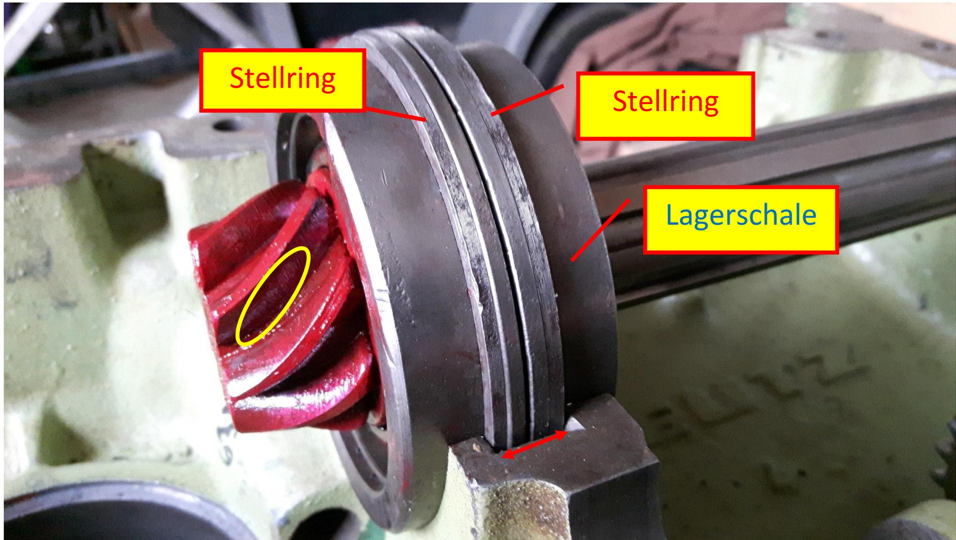
Es gibt 2 Stellringe, die auf die zweiteilige Lagerhülse über das 3309A aufgeschoben werden. Die sind evtl. anzupassen bzw. durch Papierlagen (waren bei meinem enthalten) zu korrigieren. Da darf nichts verschiebbar sein. Position ist mit Einstellvorrichtung oder nach Tragbild auf leiseste funktion einzustellen.
