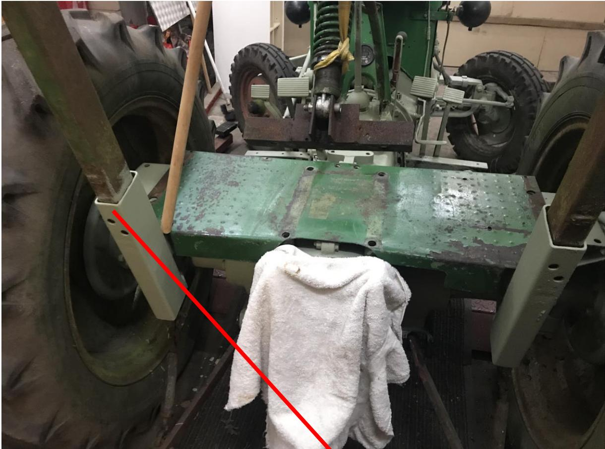
Klemmplatte Flachstahl 10\*40\*60mm, ST37
