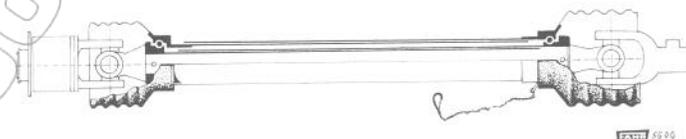
Als Schutz gegen Unfälle müssen die Gelenkwellen-Schutzrohre grundsätzlich mit der Kette an der Deichsel angehängt werden.
