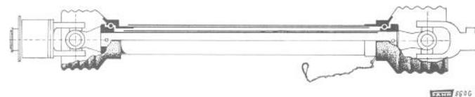
Als Schutz gegen Unfälle müssen die Gelenkwellen-Schutzrohre grundsätzlich mit der Kette angehängt werden.
