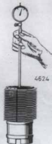
Bild 58: Messen des Zylinders mit Innenmeßgerät
