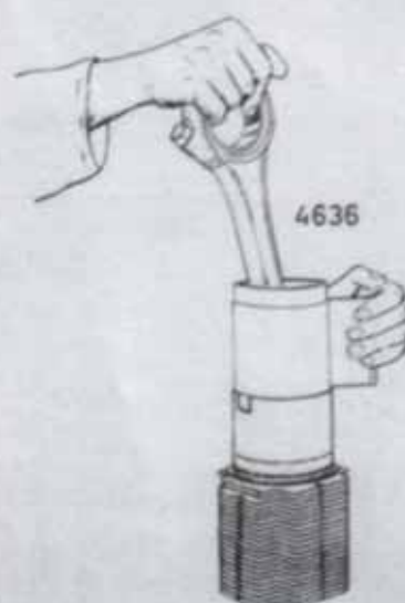
Bild 70 Einführen des Kolbens in den Zylinder
