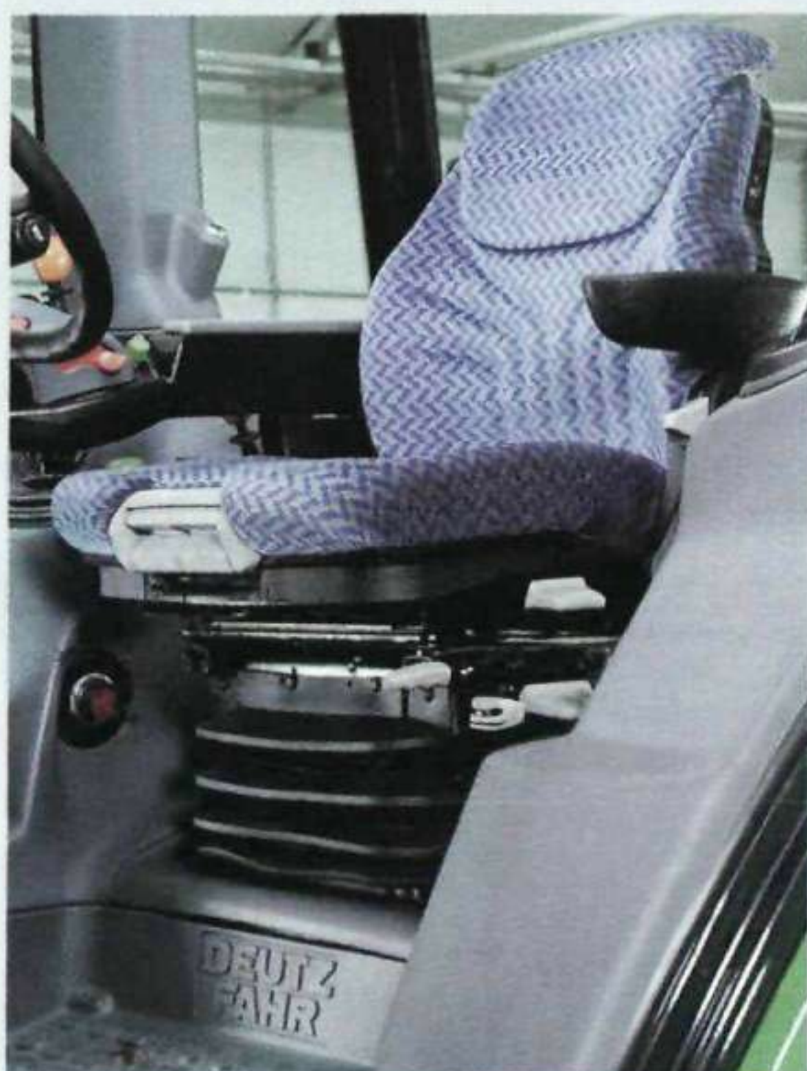
Federung von Vorderachse, Kabine und Sitz Grammer Maximo
