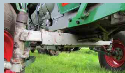
Zwecks Spurverstellung auszieh- bare Vorderachse
