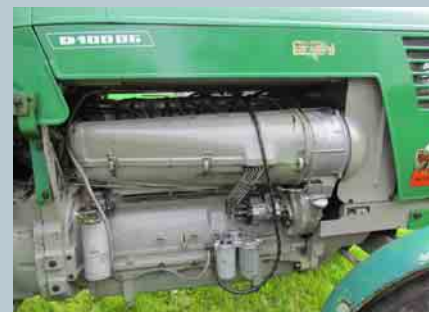
Verteiler-Einspritzpumpe im D 100 06
