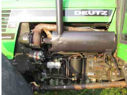
Direkt vor dem Schalldämpfer: Der Turbolader, der dem Motor 20 % mehr Leistung bringt
