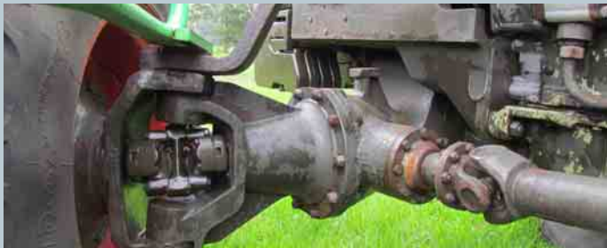
Kreuzgelenk, Differenzial und Antrieb der SIGE-Achse (ab '72)
