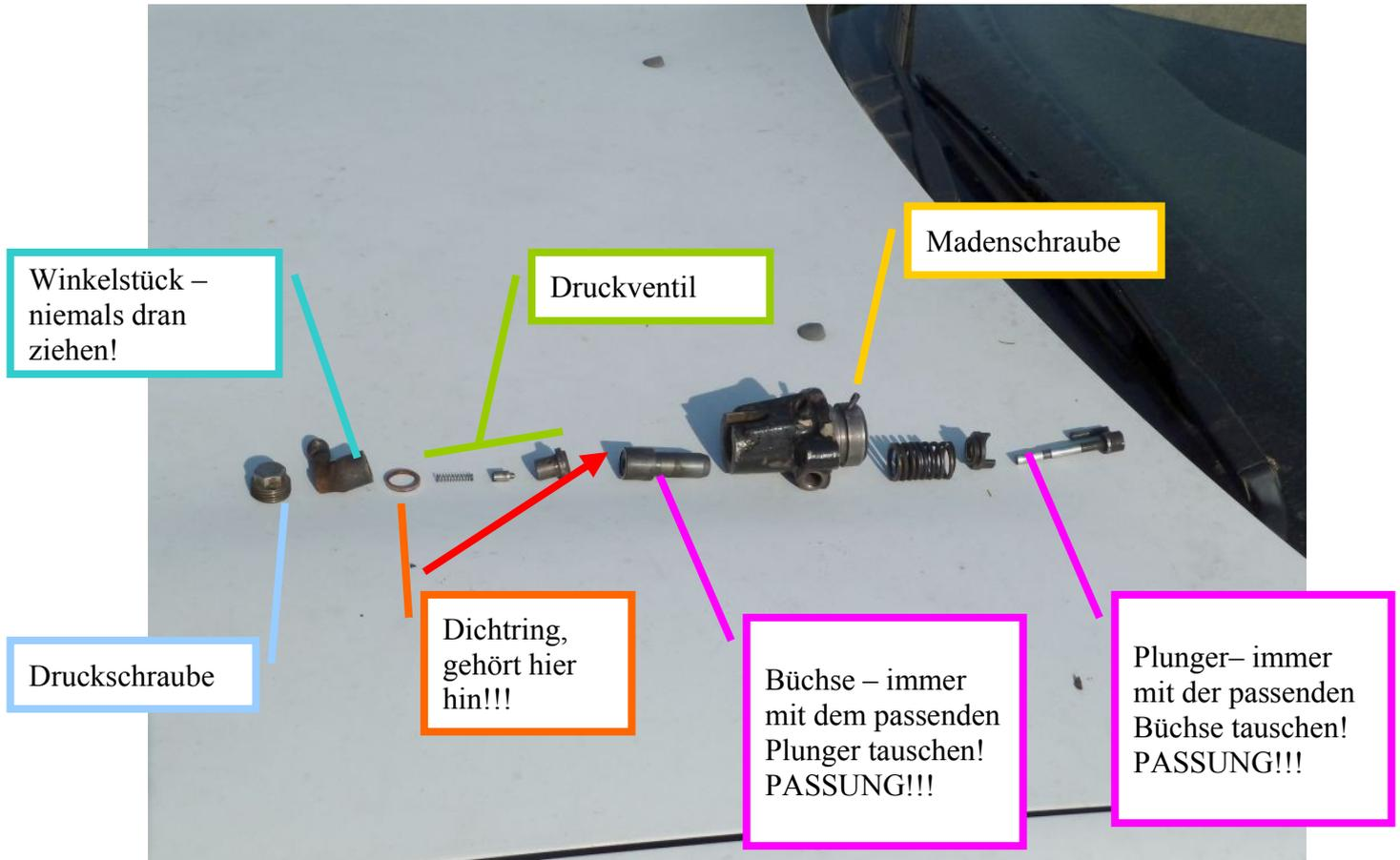
Zwischen Büchse und Gehäuse sitzt noch ein Dichtring! Der ist hier nicht ersichtlich, weil er noch im Gehäuse sitzt.
