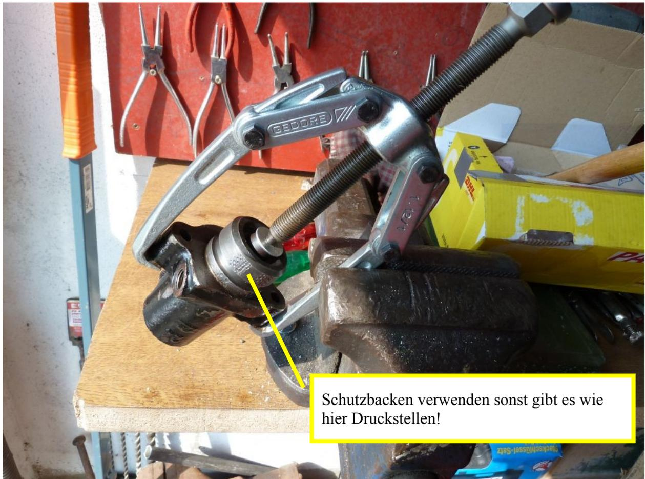
Die Druckschraube am besten bei noch montierter Pumpe mit einem Schlagschrauber lösen, denn dabei bleibt die Schraube meistens intakt. 12-kant-Ringschlüssel beschädigen meist die Kanten und danach ist die Schraube rund! Auf jeden Fall 6-kant-Schlüssel verwenden!
