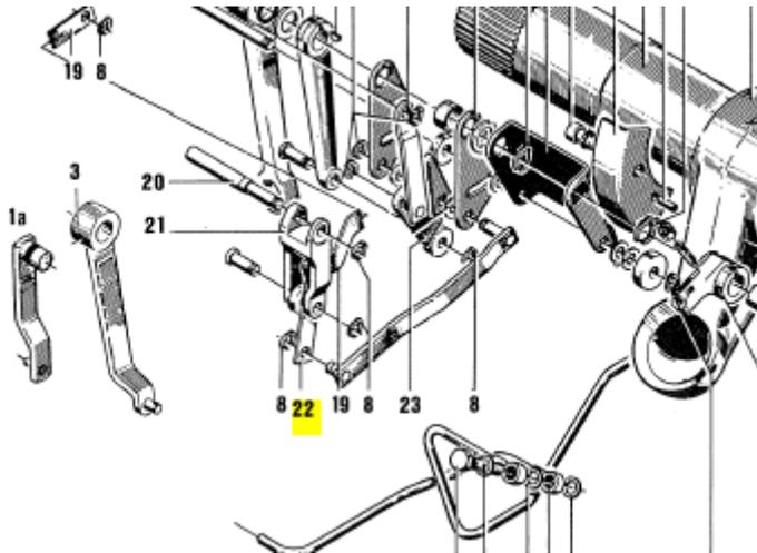
Der Hebel Bild Nr. 22 hat 2 unterschiedlich lange Schenkel. Der kürzere muss nach unten zeigen, der längere folglich nach oben. So hat das Gestänge nach unten zum Gussgehäuse Luft und kann nicht anschlagen.
