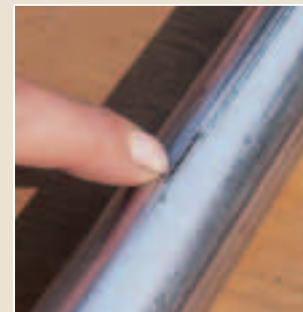
Besonders in tiefen Beschädigungen findet das Flüssigmetall ausreichend Halt.
