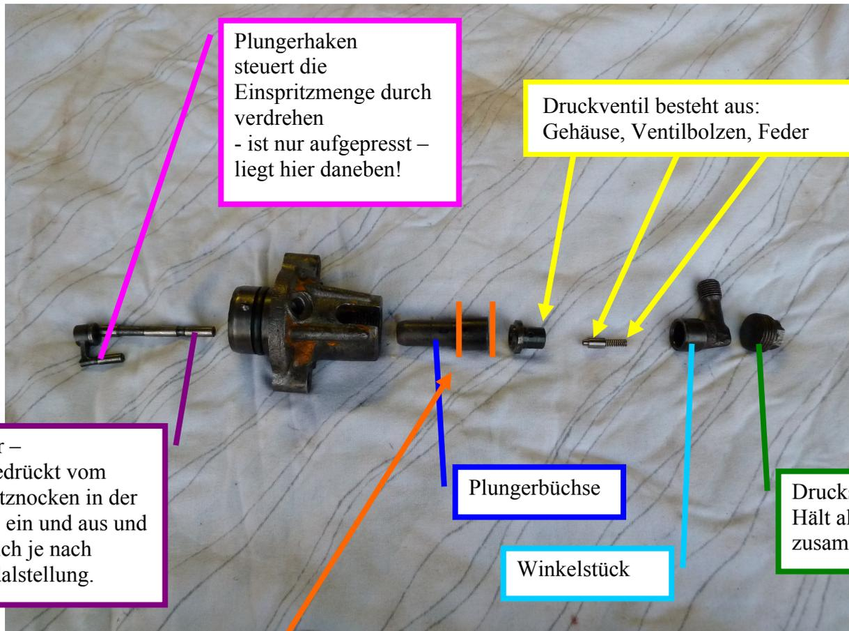
Im Bild fehlen die beiden Kupferdichtringe – als Striche Positionen angedeutet!
