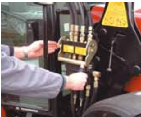
HYDRO-FIX - mit einem Griff Verbindung hergestellt.
