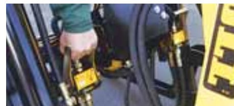
3. und 4. Steuerkreisanschluß mit HYDRO-FIX
