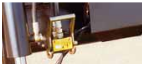
3. Steuerkreisanschluß mit HYDRO-FIX
