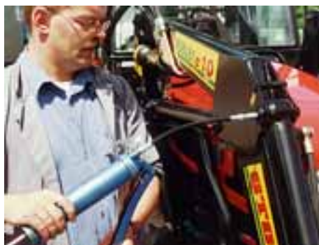
Drehpunkte von außen abschmierbar
