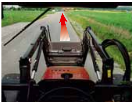
Flacher Holm aus Feinkornstahl - für freie Sicht nach vorn.
