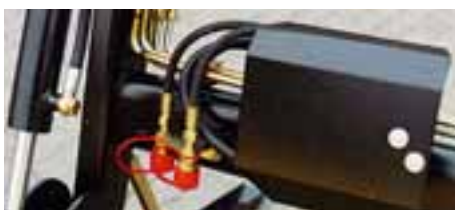
3. Steuerkreisanschluß mit Schraubkupplungen
