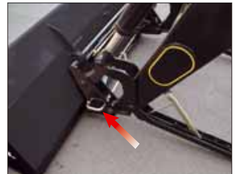
Automatische Werkzeugverriegelung - Werkzeugentriegelung von außen bedienbar - unfallsicher in der Handhabung
