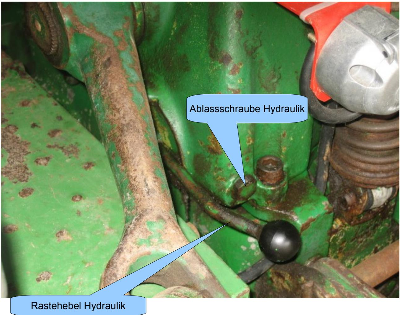
Der Rastehebel ist dazu da, die Hydraulik oben zu halten ohne Druck. Sie wird dabei über eine Welle mechanisch fixiert.
