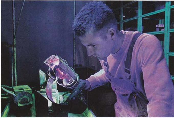
Dieser Check bleibt den gut ausgerüsteten Profis vorbehalten: Eine elektromagnetische Prüfung mit einer Spezialflüssigkeit macht...
