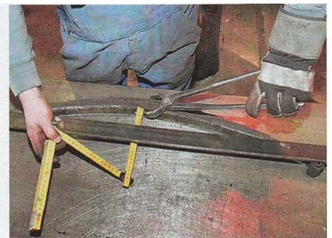
Hier wird kontrolliert, ob das gewünschte Maß der Sprengung auch erreicht wurde
