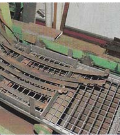
Nun steht nur noch der letzte Arbeitssgang bevor: Wenn alles passt, werden die Federblätter gestrahlt, lackiert und erst dann endgültig montiert
