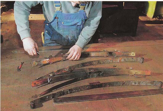
Verzichten Sie an dieser Stelle nicht darauf, die Federn zu markieren – insbesondere, wenn beide gleichzeitig zerlegt werden
