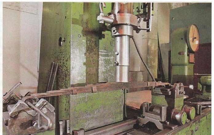
Nach der ersten Sichtung der Federpakete kommen sie vor dem Zerlegen auf den Prüfstand. Eine hydraulische Presse übt Kraft auf...
