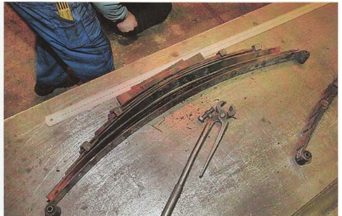
Wenn die Klammern und der Herzbolzen geöffnet sind, fällt die Blattfeder auf der Arbeitsfläche praktisch auseinander.
