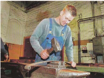
Eine Frage der Erfahrung: Gezielte Hammerschläge verleihen zunächst dem Tragblatt...
