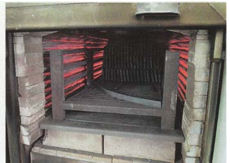
...auf rund 500 Grad in einem zweiten Ofen macht das Blatt wieder elastisch
