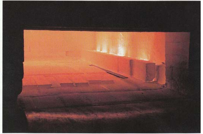
Um das neue Federblatt in Form zu bringen, ist reichlich Hitze nötig. Also wird es in einem rund 1000 Grad heißen Ofen glühend gemacht
