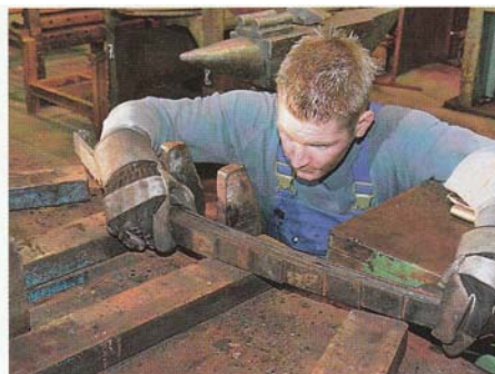
Kontrolle ist besser: Check des Federpakets beim provisorischen Zusammenbau
