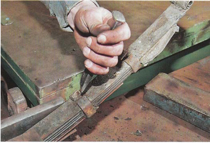
Als nächster Arbeitsschritt steht das Zerlegen an: Im Fall der Austin-Federn sind zwei Federklammern mit Nieten gesichert
