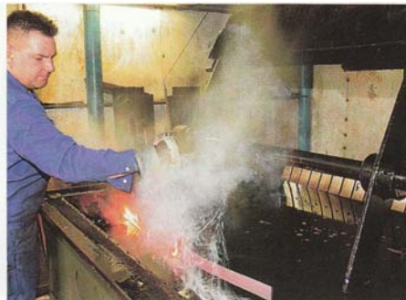
...und dann zum Härten in Spezialöl getaucht. Erst das langsame Anlassen...
