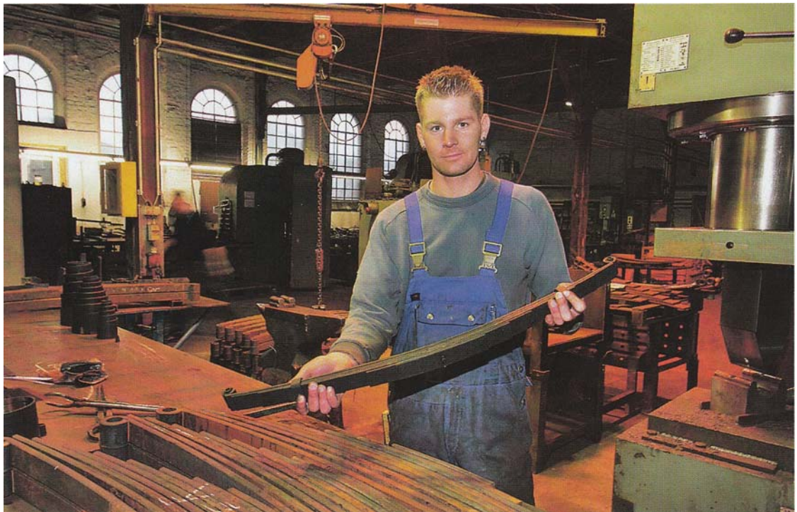
Nun steht nur noch der letzte Arbeitssgang bevor: Wenn alles passt, werden die Federblätter gestrahlt, lackiert und erst dann endgültig montiert
