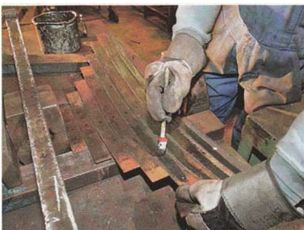
Um das Messergebnis nicht durch Reibung zu verfälschen, werden die Blätter gefettet
