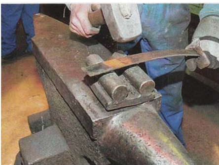
Wichtig: Beim Formen der einzelnen Blätter immer von der Mitte nach außen vorarbeiten
