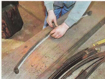
...die gewünschte Kontur, die mit Kreide auf die Arbeitsfläche übertragen wird
