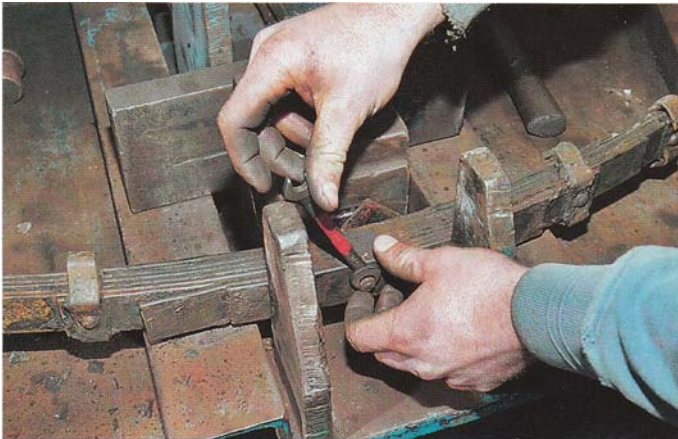
Bevor der Herzbolzen gelöst wird, der das Federpaket in der Mitte zusammenhält, sollten Sie die Feder in einem Schraubstock fixieren.
