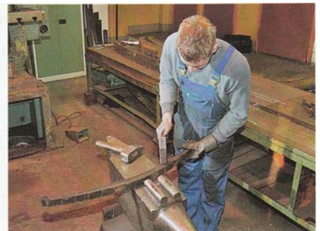
Leichte Hammerschläge helfen beim Ausrichten der einzelnen Blätter
