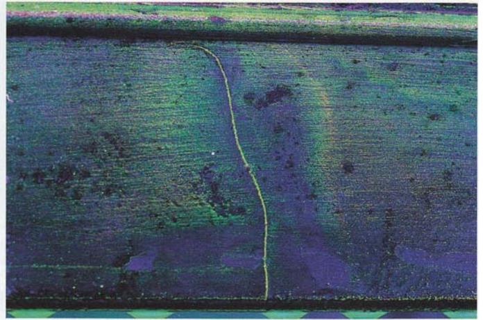
...unter UV-Licht auch kleinste Risse sichtbar. Federblätter mit Rissen sind ohne Wenn und Aber ein Fall für den Schrott
