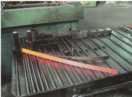
Wenn das glühende Blatt aus dem Ofen kommt, wird es grob in Form gebracht...
